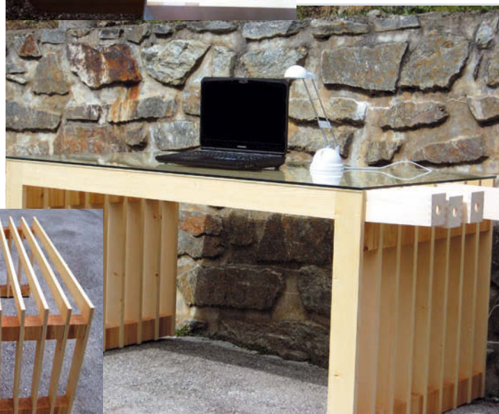
Simon Goller verwendete für seinen Schreibtisch Fichten- und Lärchenholz. Die Tischplatte ist aus Glas, was dem Möbel eine besondere Leichtigkeit verleiht. Die Schubladen zwischen den Elementen sind ein besonderes Detail
