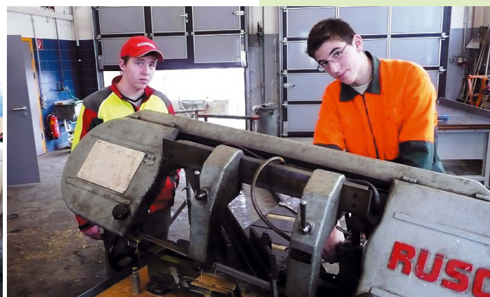
Michael Walder beim Verschrauben der Wasseranschlüsse (li), gemeinsam mit Lukas Holzer schneidet er mit der Bandsäge den Winkelstahl (ca. 5 m) für den Rahmen der Tränke zu (re)
